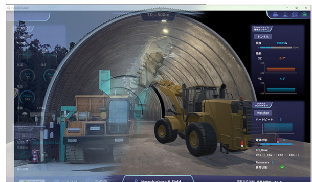
西松建設株式会社「山岳トンネルデジタルツイン基盤における可視化技術」
